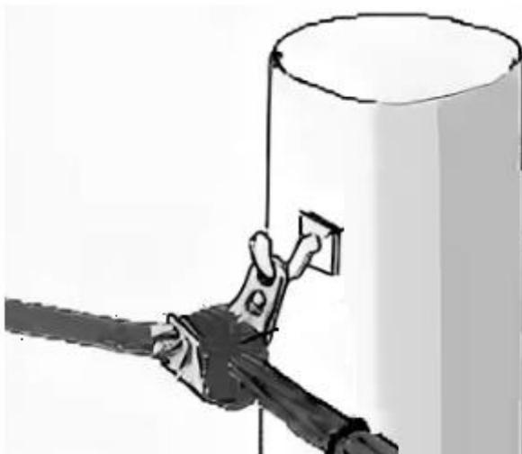
**Запрещено применять данные зажимы для проводов без изоляции!**
