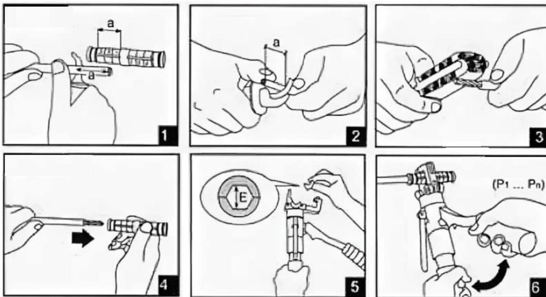
**Запрещено применять данные гильзы для проводов без изоляции!**
